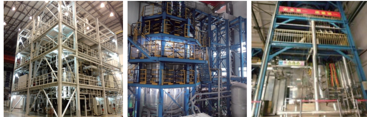
非能动堆芯冷却系统性能试验
